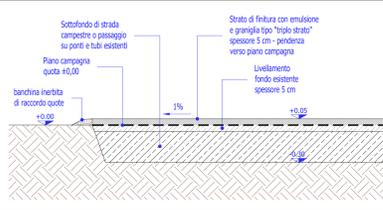
TIPO 2 - PISTA IN ASFALTO - ROTATORIA S.P. 163 - 1:20
